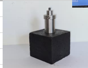
Eindringversuch bei 40°C- 525N (Würfel)
