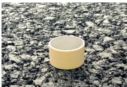
Abb.1: Temperatursensor (Höhe = 1,2 cm oder 1,7 cm, Durchmesser = 3 cm) vor dem Einbau der Asphaltdeckschicht
