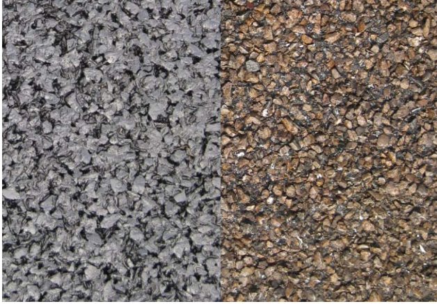
Vergleich der Oberflächentexturen von PMA (links) und lärmarmem Gussasphalt (rechts)
