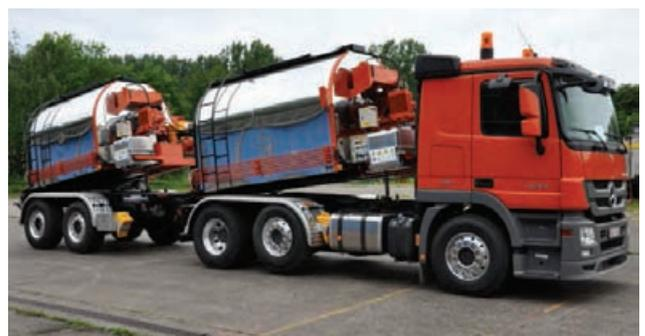
Transportkocher sind Rührwerkskessel, die auf LKW-Trägerfahrzeugen und -Anhängern aufgebaut sind und während des Transports und der Wartezeit auf der Baustelle bis zum Einbau das Homogenisieren und die Temperaturüberwachung des Gussasphalts übernehmen.
