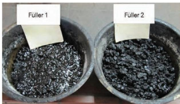
*Fließfähiger, gut einbaubarer Gussasphalt unter Verwendung des geeigneten Füllers*
