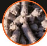
Lucocell® FG3000 ist ein Zellulose-Additiv für SMA.
