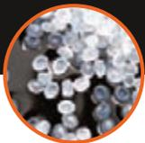
Lucolast® 7010 ist ein Copolymer aus Ethylen und Butylacrylat mit einer geringen Kristallinität.
