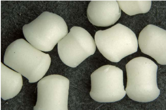
Das Schmelzklebgranulat Sikalastic-827 HT von Sika Deutschland mit einer Körnung von ca. 1,5 mm
