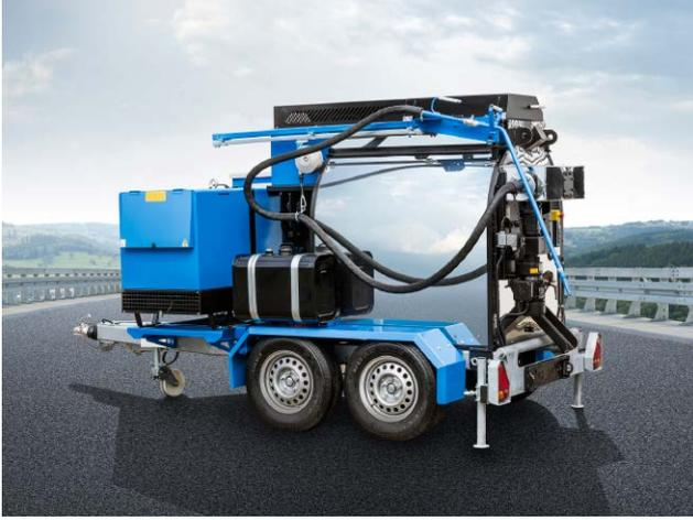
*Mit ebenfalls direkten elektrischen Antrieb des Rührwerks kann der Fugenvergusskocher ohne belästigende Abgase oder Geräusche zu erzeugen, auch in Tiefgaragen eingesetzt werden.*
