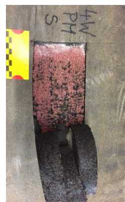
Trennfall c: Wie Trennfall b, jedoch ohne verbleibende Klebmassereste auf der Epoxid- harzoberfläche
